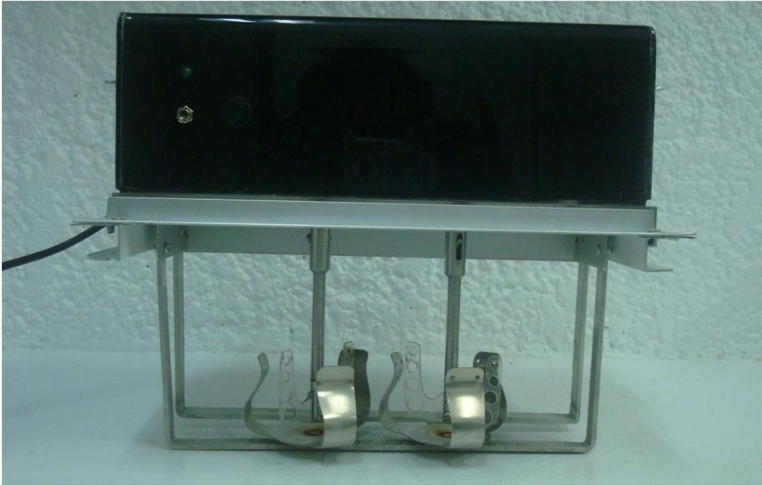
Equipo diseñado (Departamento de instrumentación, CICY), para mantener la temperatura homogénea en la suspensión de harina durante su calentamiento.
