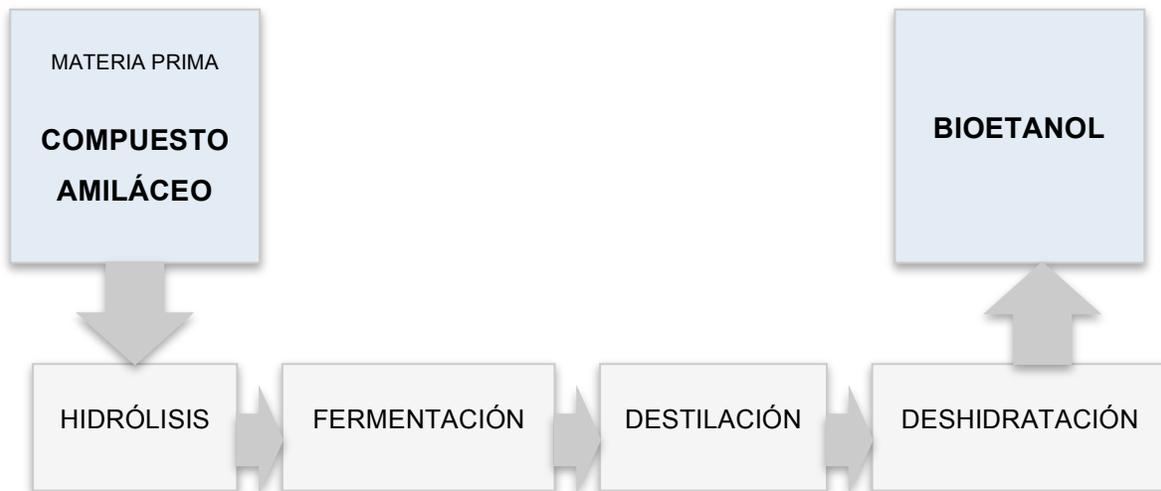
Figura 1.3. Proceso de producción de bioetanol a partir de compuestos amiláceos.
